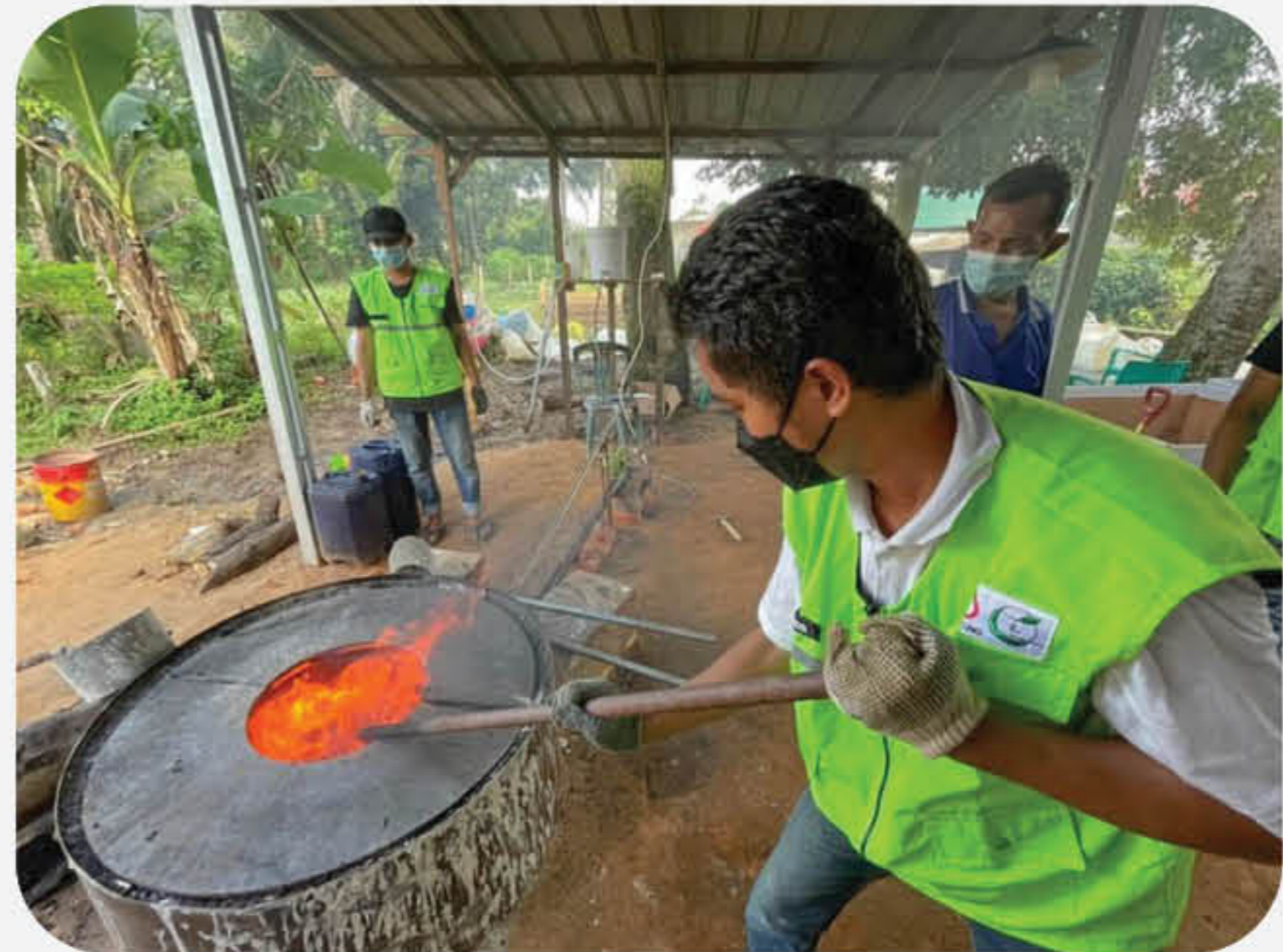
Proses kegiatan peleburan aluminium oleh Bank Sampah Telihan Recycle
